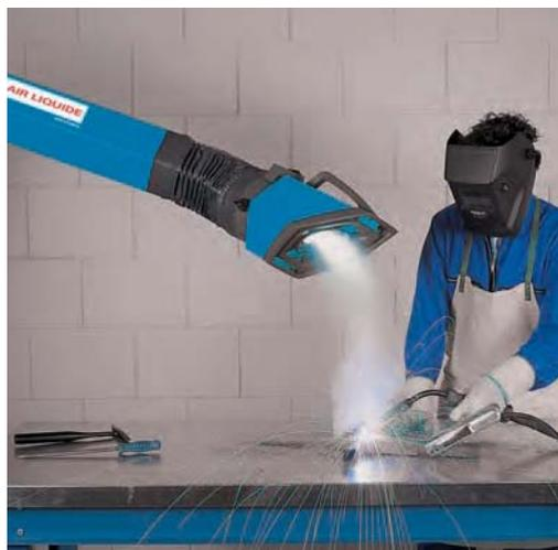
**Aspiratore carrellato con sistema di filtrazione elettrostatica composta da: prefiltro metallico, cella ionizzante, cella filtrante, post-filtro metallico.**
