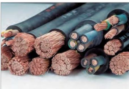
I cavi secondari di saldatura sono cavi in rame rivestiti in gomma che collegano il generatore di corrente alla massa e alla pinza/torcia di saldatura. L'indicazione della corrente è la massima utilizzabile in conformità alle raccomandazioni CEI 287. Per lunghezze superiori ai 10 metri è necessario aumentare la sezione del cavo.
